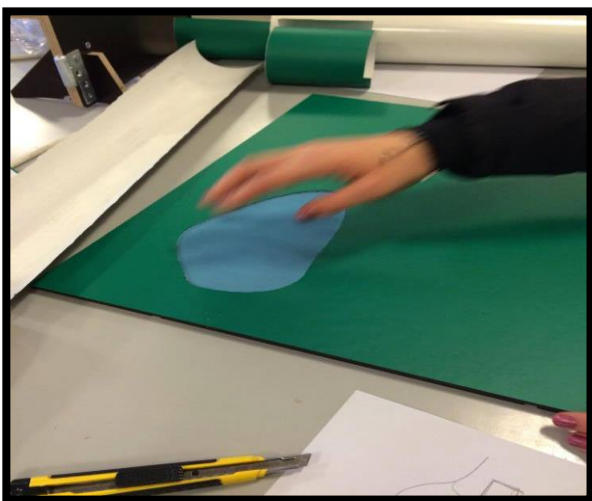
Blå akrylplade samt et stykke hvidt papir, udfylder hullet i øverste plade for at danne en sø.
